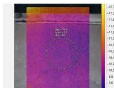
Termovizní snímek na stěnu při začátku zkoušky, povrchové teploty na neohřívané straně byly cca 10°C.
