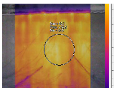
Po více jak dvou hodinách byly povrchové teploty na neohřívané straně max. kolem 60°C.
