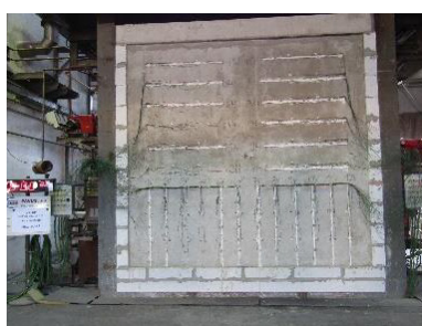
Zkouška požární odolnosti spár.
