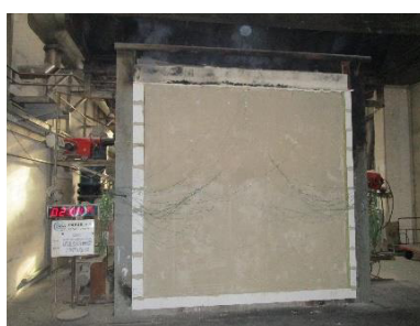
Zkouška požární odolnosti stěny.
