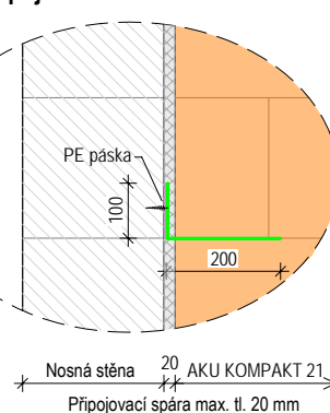
Detail napojení stěn - D1
