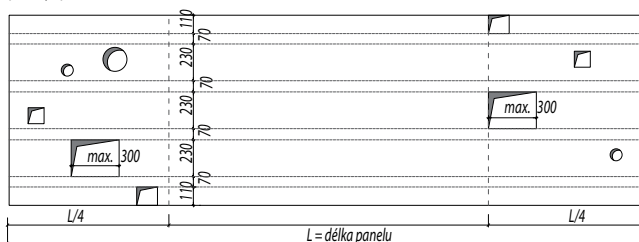
Vytvoření dodatečných prostupů v panelu půdorys panelu
