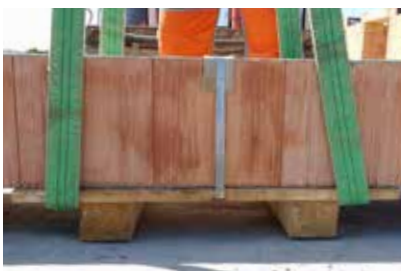
⑦ Detail provléknutí popruhů pod paletou.
